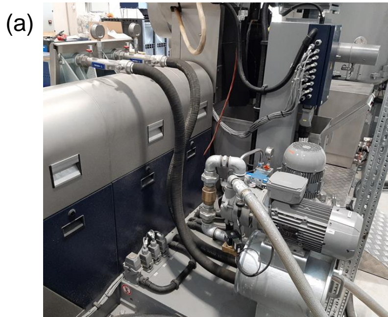
Entgasungsleitungen (a) ursprünglich (b) nach Modifikation
